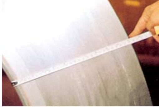
◀ Detalhe da parede de um vaso de alta pressão, construído com seis camadas de 46mm de espessura cada.
